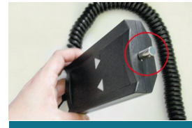
SWITCH DE SEGURIDAD Si se extrae el switch del mando, este no funciona, evitando posibles accidentes o un uso no deseado
